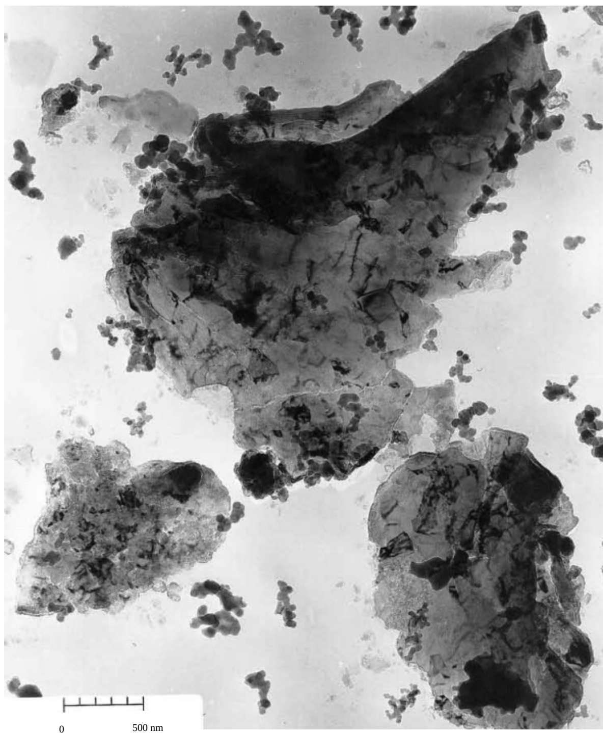
图A.8 柴油机尾气烟灰，标尺=500 nm
