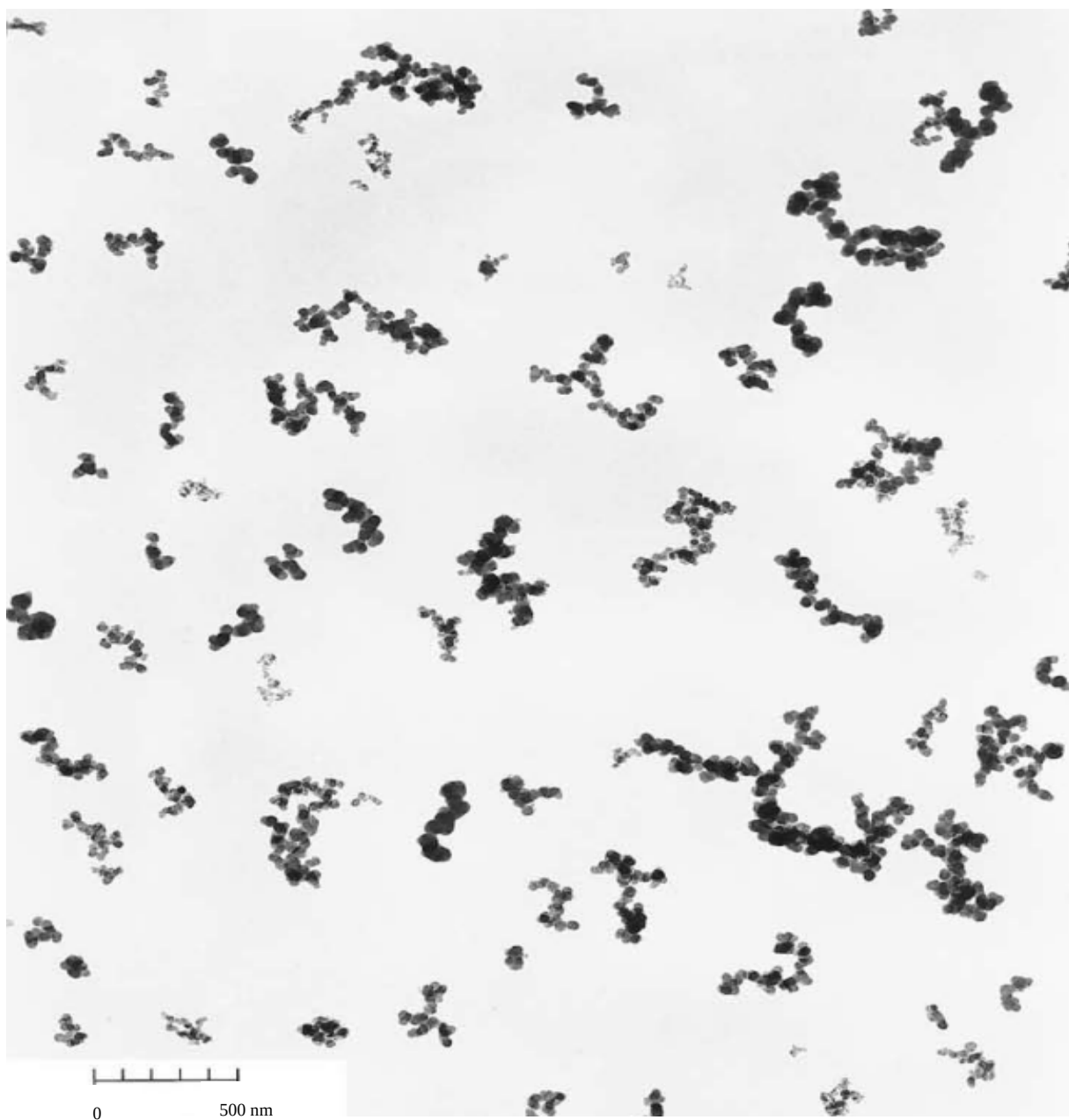
图A.4 实验室尾气（甲苯）烟灰，标尺=500 nm
